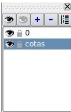
En QCad encontramos un sistema de capas. Las capas actúan como el papel cebolla. Puedes colocar una encima de otra y observar el resultado de la superposición en el área de trabajo. Esto es muy útil porque puedes hacerlas invisibles, cambiar el tipo de trazo, el color o el grosor de las líneas para toda esa capa. Puedes encontrar la ventana de capas en la parte superior derecha de la ventana de QCad.
